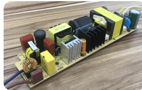
60W 全压两级 式 高PF无频闪驱动
