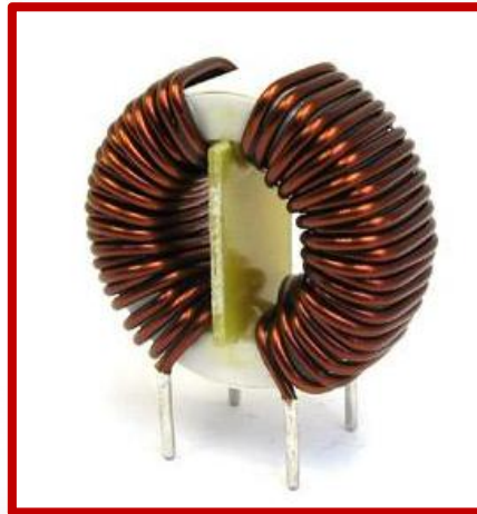
规格型号：DY302015HB 材质：1K107 铁基纳米晶 电感：10KHz L=4mH MIN 100KHz L=1.6mH MIN 使用频率：1KHZ-200KHZ
