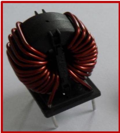
规格型号：DY332320HB 材质：1K107 铁基纳米晶 电感：1KHz L=10.3mH MIN 200KHz L=5.7mH MIN 使用频率：1KHZ-200KHZ
